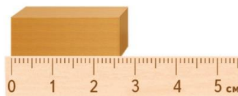
Рис. 10. Определение цены деления линейки
